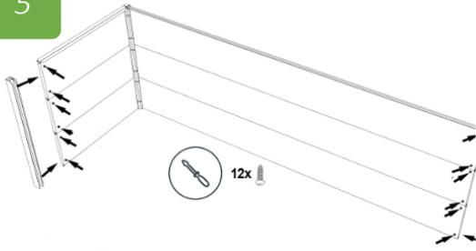
Eckwinkel an die Enden einer montierten Bretterwand festschrauben
