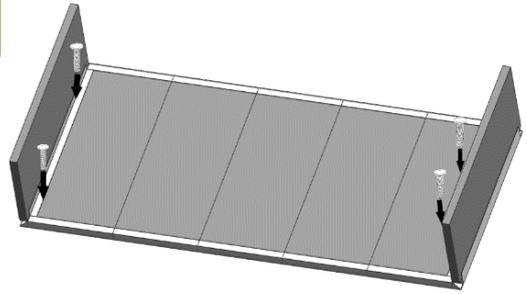
Seitenplatten an Eckwinkel festschrauben
